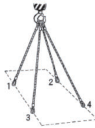
Hình 5-15 Hướng chiều dọc vuông góc với hướng của móc (1-3-2-4 hoặc 3-1-4-2 từ đầu móc)
