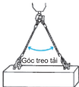
Hình 3-4 Góc treo tải để Treo hai dây với Hai điểm
